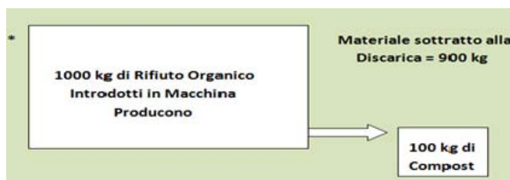
(*) Schema della riduzione in volume
